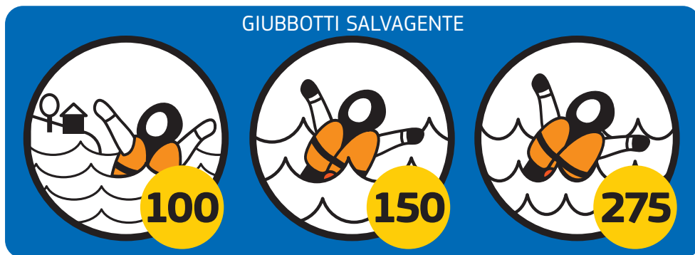
VI-1. Livelli di galleggiamento per giubbotto di salvataggio individuale (adattamento da RNLI).
